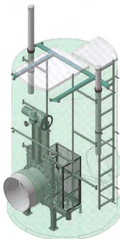
Рис.26. Колодец с сороудерживающей корзиной и шиберным затвором
