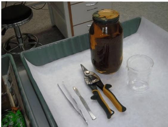
Рисунок Б-3 – Стекло́нный сосуд с завинчивающейся крышкой с образцами целлюлозной изоляции в масле и подготовленное рабочее место
