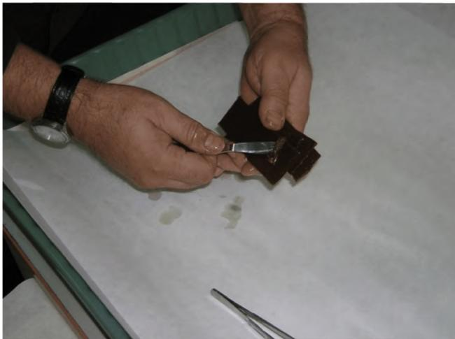
Рисунок Б-6 – Разрезание шнура, связывающего образец
