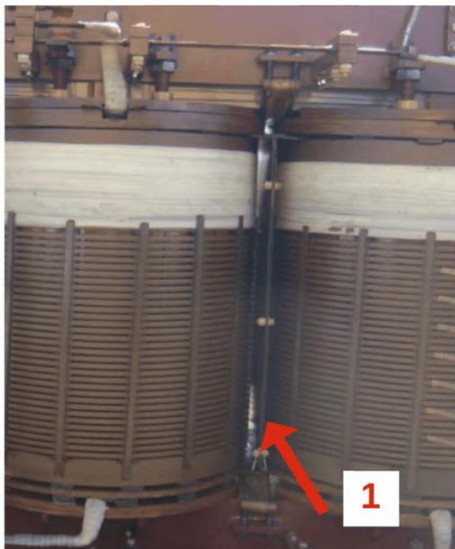
Рисунок 4 – Пример конструкции с вводом напряжения с верхнего торца обмотки ВН
