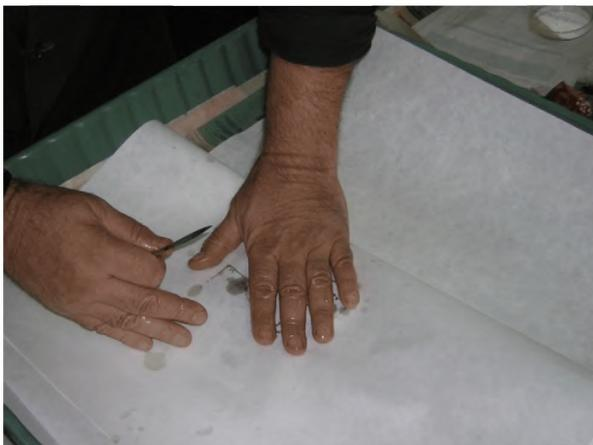
Рисунок Б-7 – Протирка образца фильтровальной бумагой
