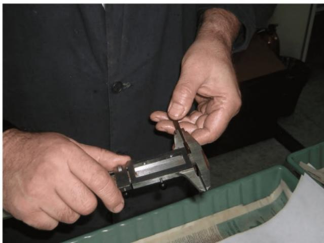
Рисунок Б-9 – Измерение толщины образцов изоляции
