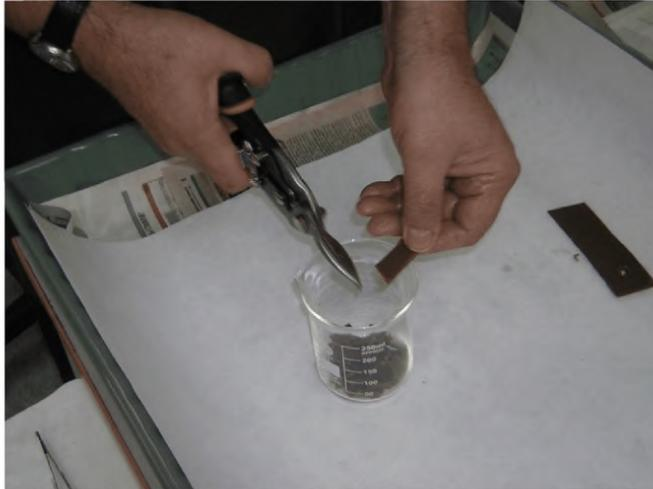
Рисунок Б-10 – Подготовка навески образца изоляции
