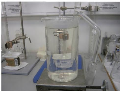
Рисунок Б-16 – Ловушка, помещенная в стакан с горячей водой
