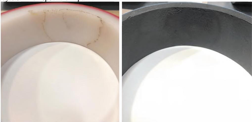
Б.6. Оценка результатов проверки делается не только по внешнему виду трубы после окончания воздействия пламени, но и по поведению трубы непосредственно в момент воздействия пламени. Поэтому в рамках проверки следует проводить и фото, и видеоФиксацию.
