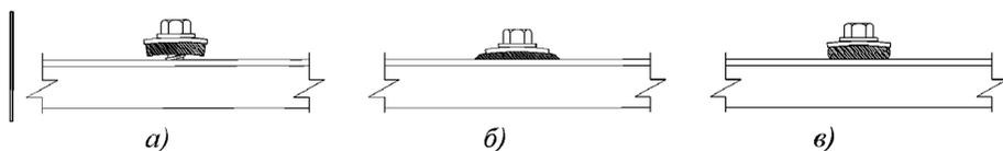
Рисунок 25 - Правильность установки винтов с EPDM шайбой
