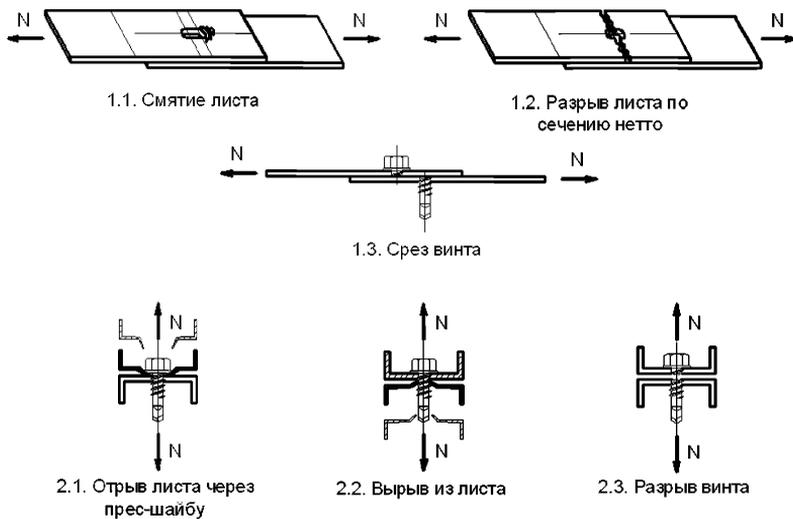
Рисунок 17 - Типы отказа винтовых соединений
