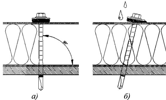
Рисунок 27 - Угол установки винтов
