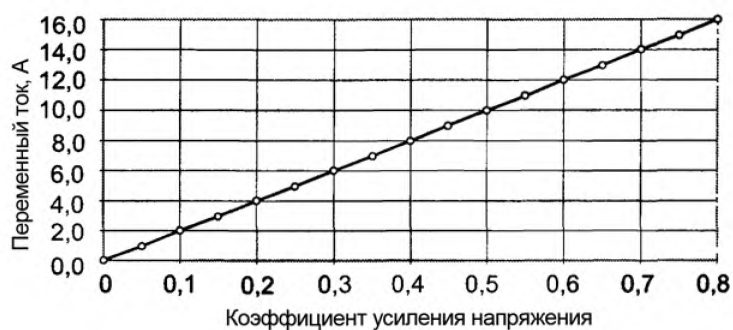
Рисунок D.1 – Отношение переменного тока питающей сети к измеряемому коэффициенту усиления напряжения
