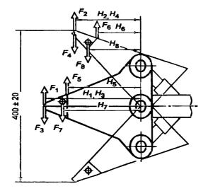
$H_1$  – плечо силы  $F_1$  относительно оси поворота губок,  $H_2$  – плечо силы  $F_2$  относительно оси поворота губок,  $H_3$  – плечо силы  $F_3$  относительно оси поворота губок,  $H_4$  – плечо силы  $F_4$  относительно оси поворота губок,  $H_5$  – плечо силы  $F_6$  относительно оси поворота губок,  $H_7$  – плечо силы  $F_6$  относительно оси поворота губок,  $F_8$  – плечо силы  $F_8$  относительно оси поворота губок.
