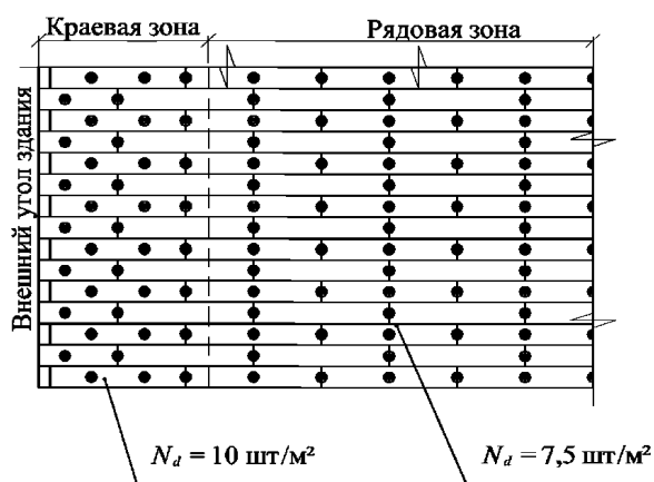
Пример фрагмента теплоизоляции стен выше отм. + 40,0 от уровня отмостки здания
