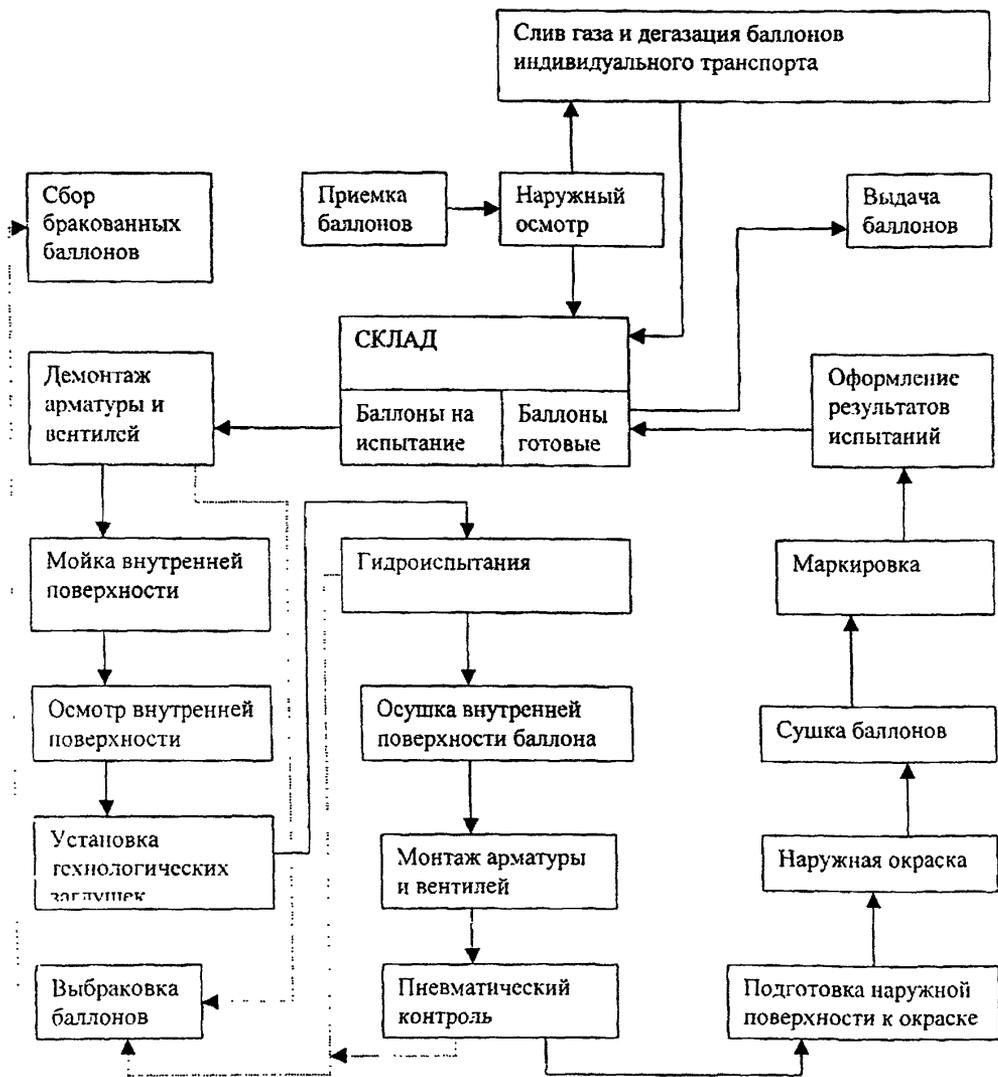
Рис. 9.1. Схема технологического процесса освидетельствования баллонов для ГСН
