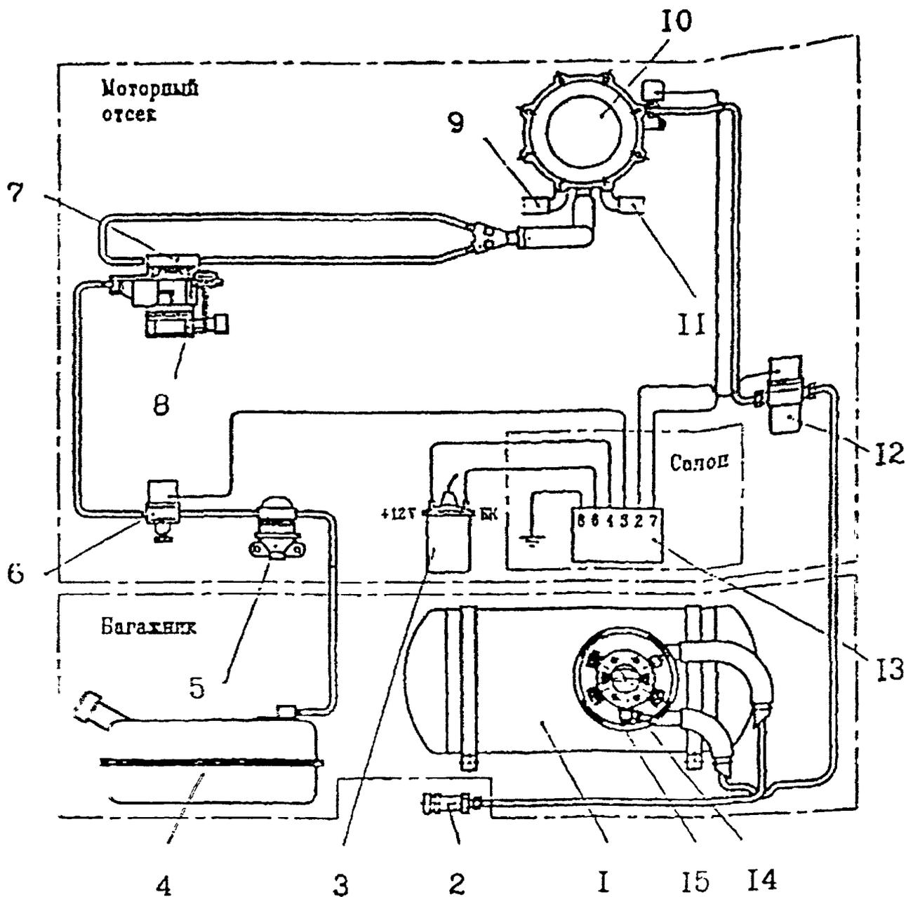
**Рис 3.2. Схема принципиальная газобаллонной установки АО «ЭКОРТ» для легковых автомобилей:**
