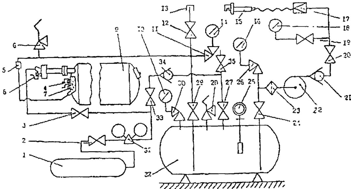
Рис. 5.2. Технологическая схема установки для слива ГСН (вытеснительный вариант):
