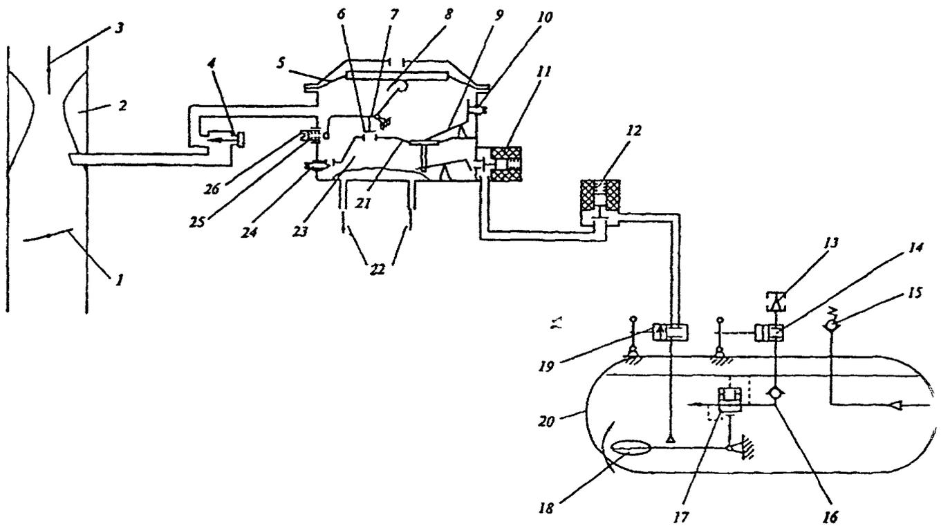
**Рис. 3.1. Принципиальная схема основных элементов ГБО для ГСН:**
