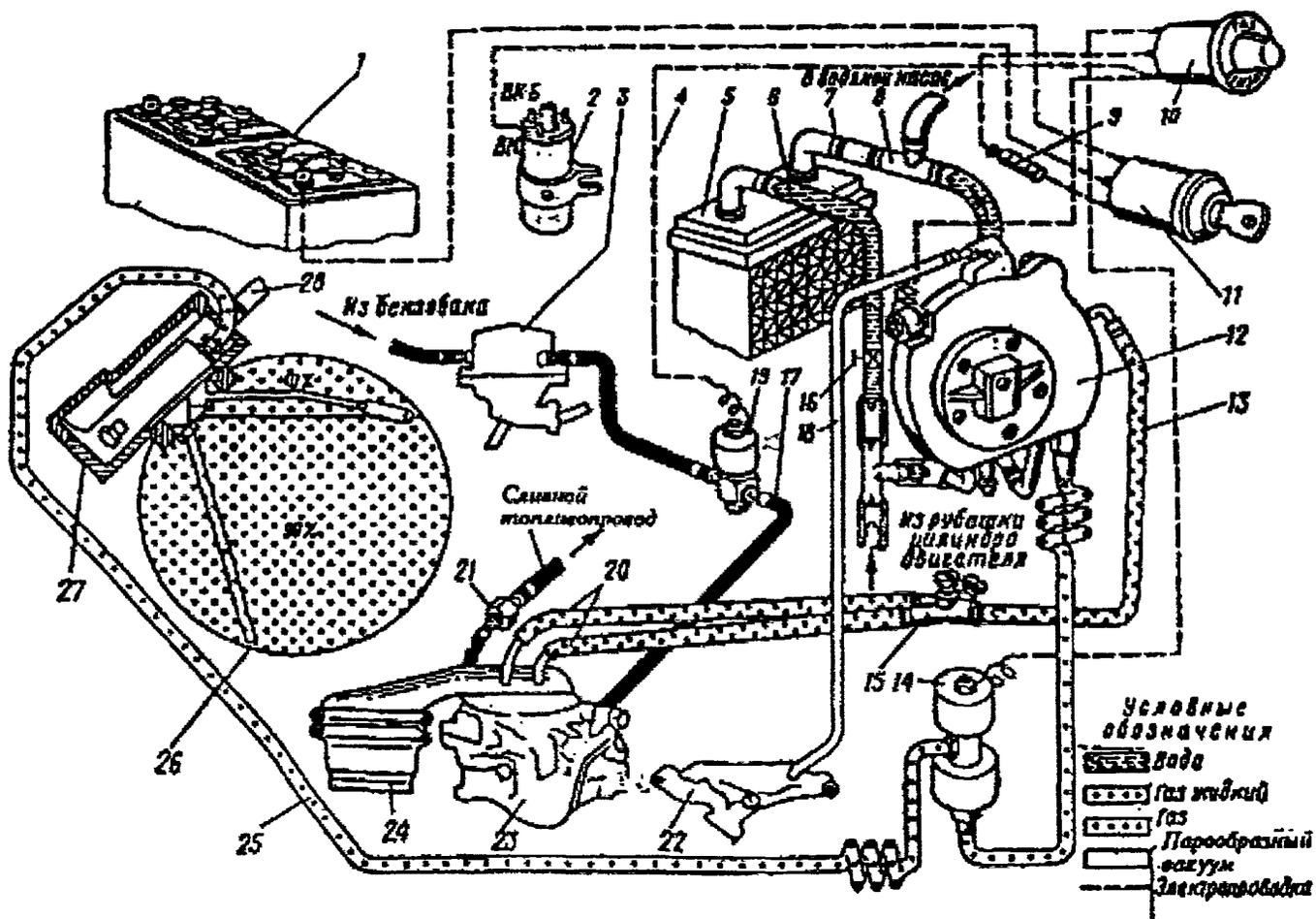
**Рис. 3.5. Схема газобаллонной аппаратуры Новогрудского завода:**
