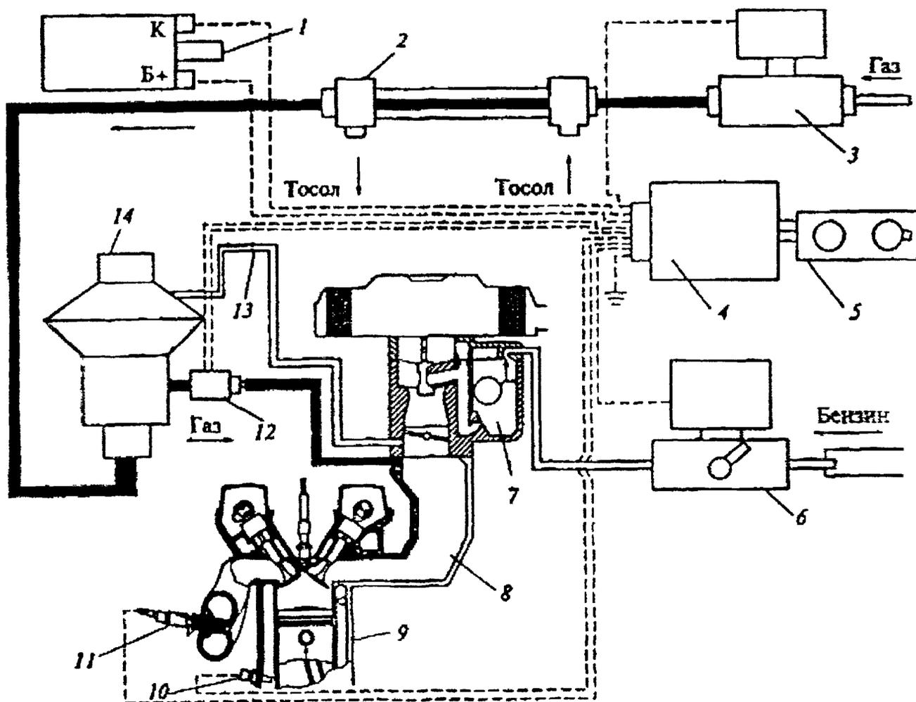
Рис. 3.10. Схема инжекторной системы дозирования газового топлива:
