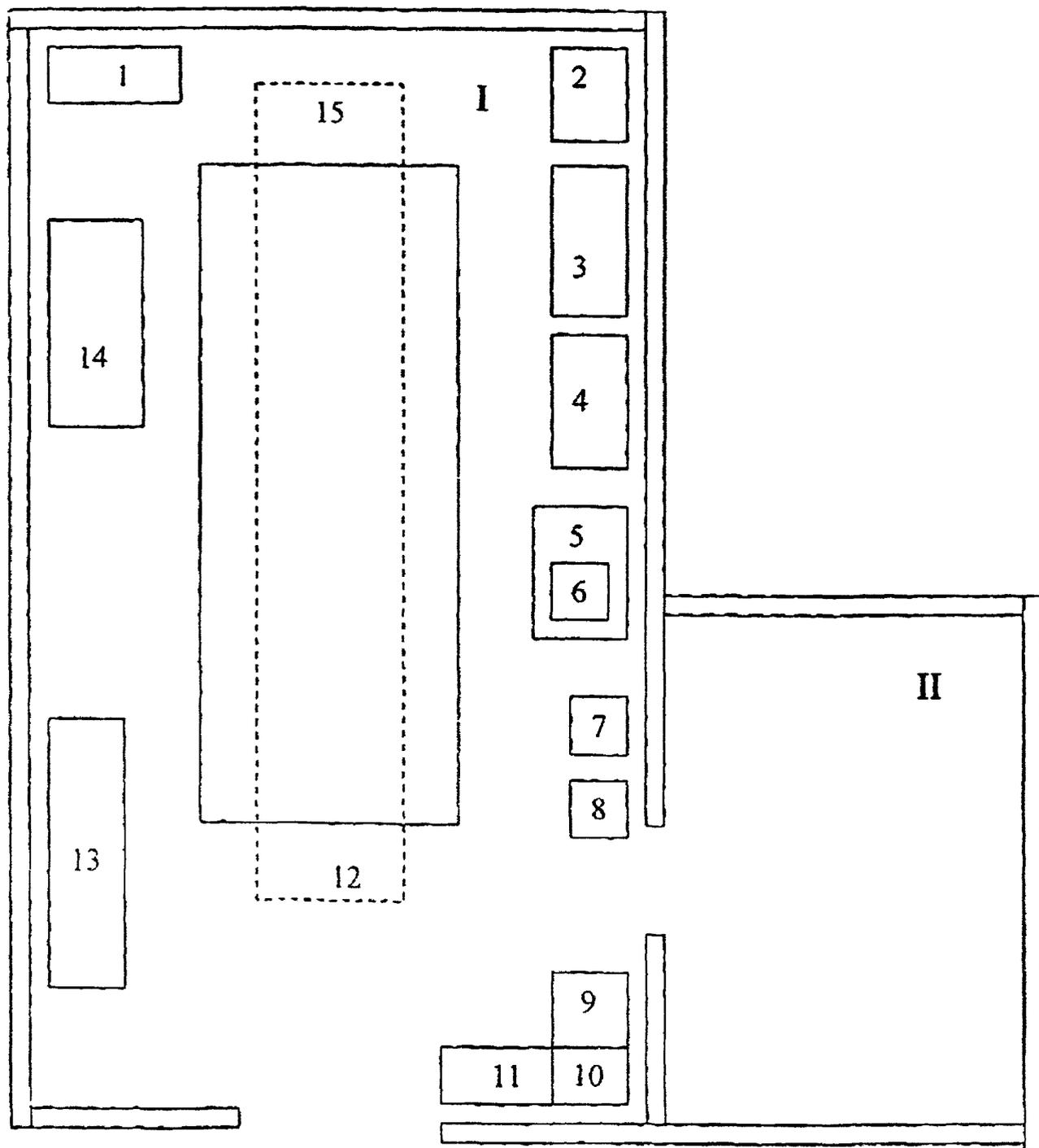
**Рис. 5.6. Участок ТО и ТР газобаллонных автомобилей:**
