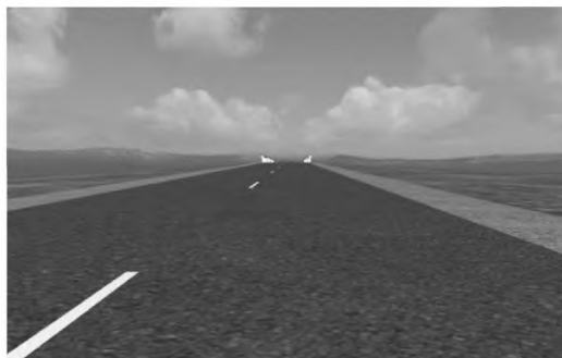
Рисунок 40 – Кривая малого радиуса в конце подъема, расположенного на прямой в плане
