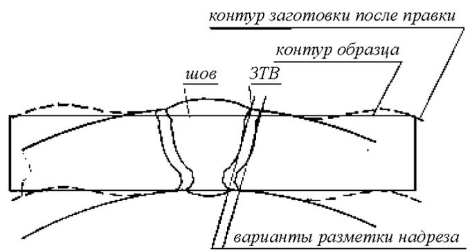
Рис. 5.4.4.3 Разметка образцов из трубы
