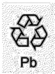
Рисунок 6 — Пример маркировки с символом переработки свинцово-кислотных батарей
