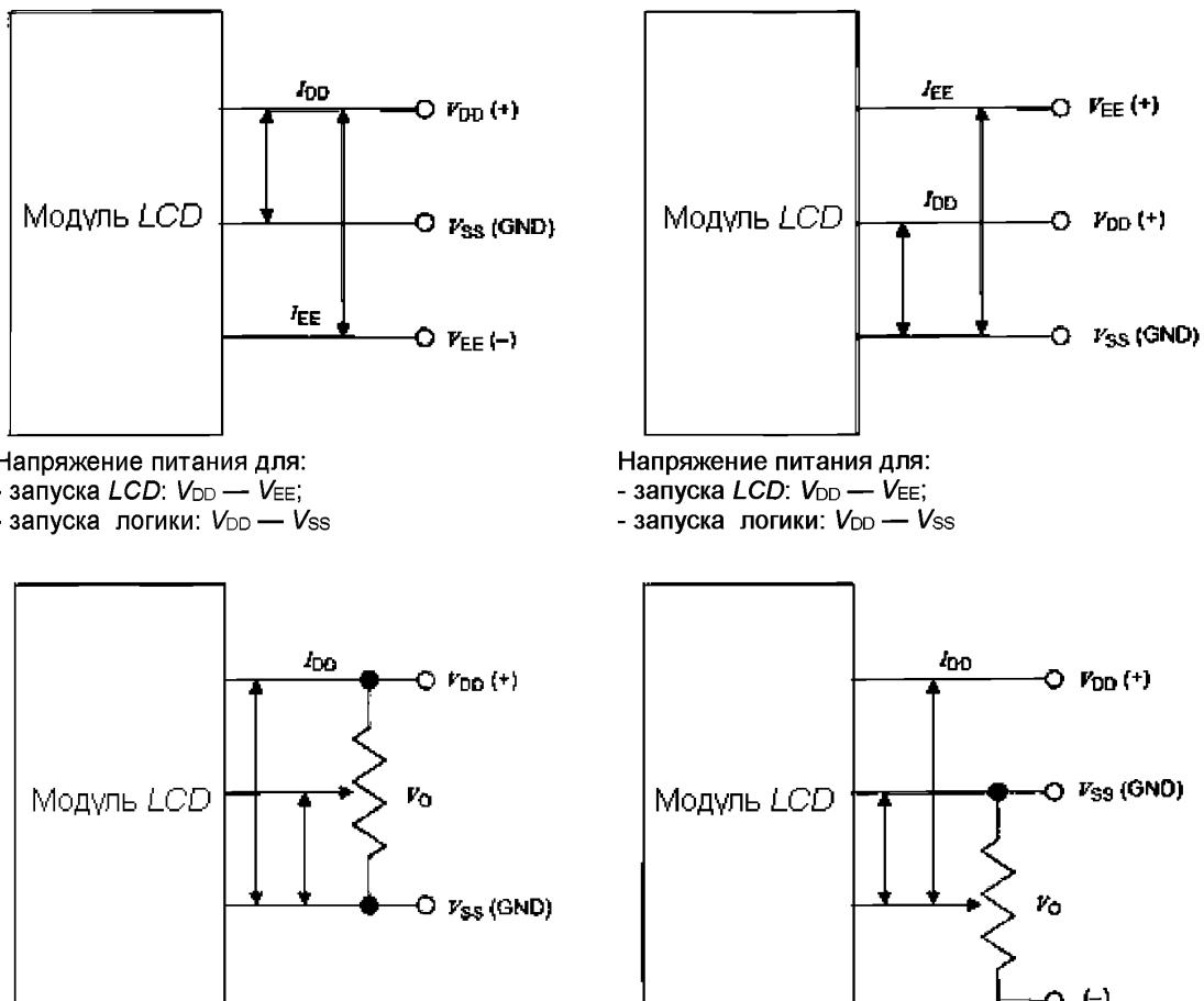
Рисунок 1 – Блок-схема с указанием напряжений питания
