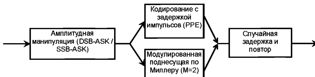
Рисунок 8 — Структура радиочастотной метки типа D
