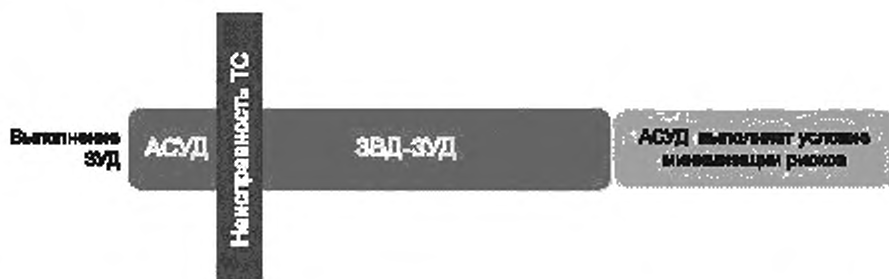
Рисунок Б.4 — Последовательность событий в системе 4-го уровня: АСУД активна, в ТС происходит системный сбой, не позволяющий продолжить выполнение ЗУД. АСУД выполняет ЗВД и условие минимизации рисков.
