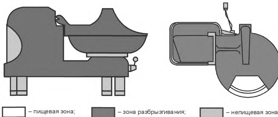
Рисунок 9 – Гигиенические зоны куттера типа 1
