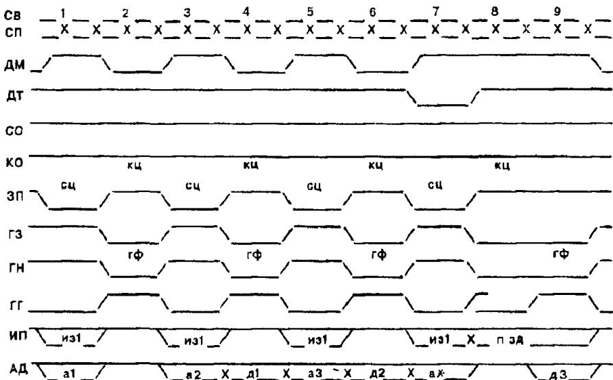
Рисунок Б.6 — Временные диаграммы расщепленных циклов чтения, проводимых одним задатчиком
