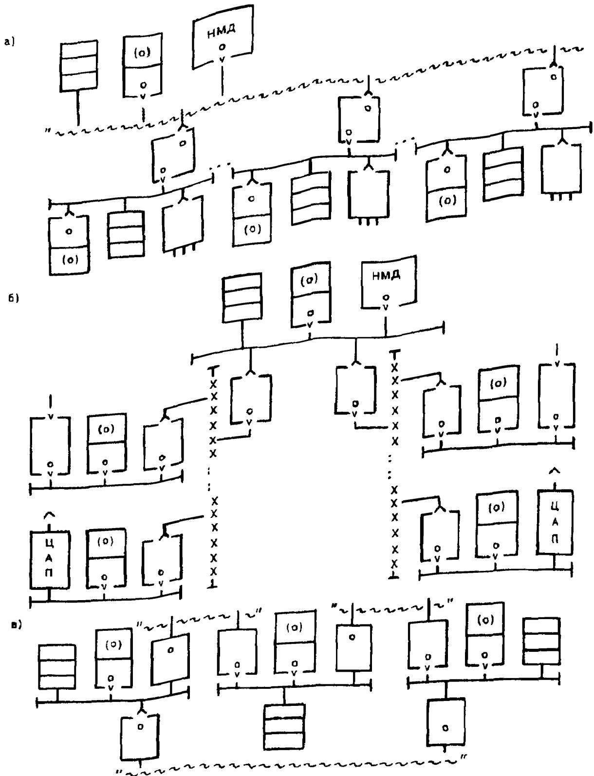
а) двухуровневая линейная структура на основе кабельной межкаркасной магистрали    б) трехуровневая древовидная структура    в) колецевая структура
