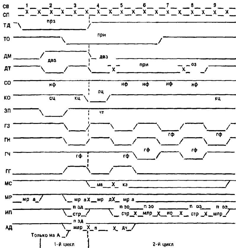
1-й цикл — ЗД на ШР, 2-й цикл — ЗО и ОЗ на ШС — 2-й (совмещен с единичным циклом чтения)
