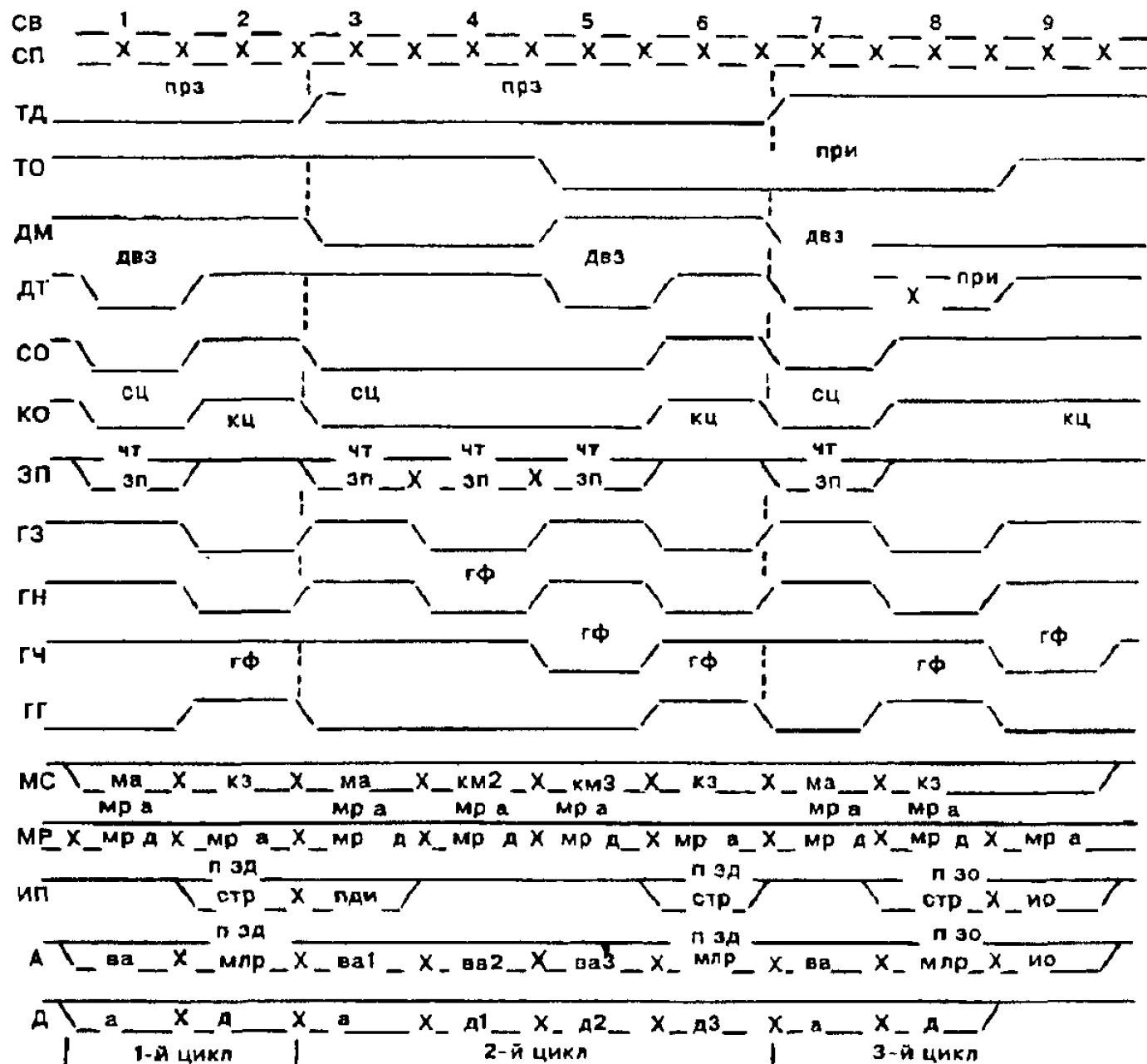
1-й цикл — единичный цикл передачи данных; 2-й цикл — множественный цикл передачи, совмещаемый с циклом арбитража ЗД (в каждой фазе обращение по произвольному ВА модулей);
