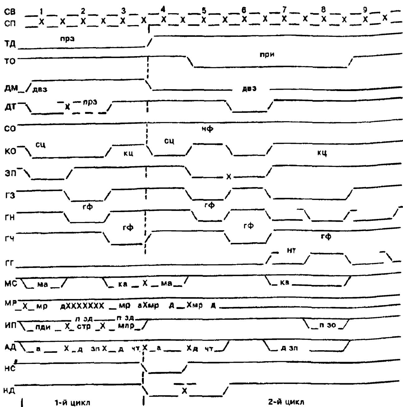
1-й цикл — в цикле «запись-чтение-проверка», закончившемся диагностическими сигналами  $НС = НД = 1$ ; 2-й цикл — в цикле «чтение-модификация-запись» (с диагностикой  $НД = 1$  в фазе обращения), в середине которого проходит арбитраж ЗО с участием медленного исполнителя; задатчик на время модификации данных вставляет нулевые фазы для работы шины приоритета
