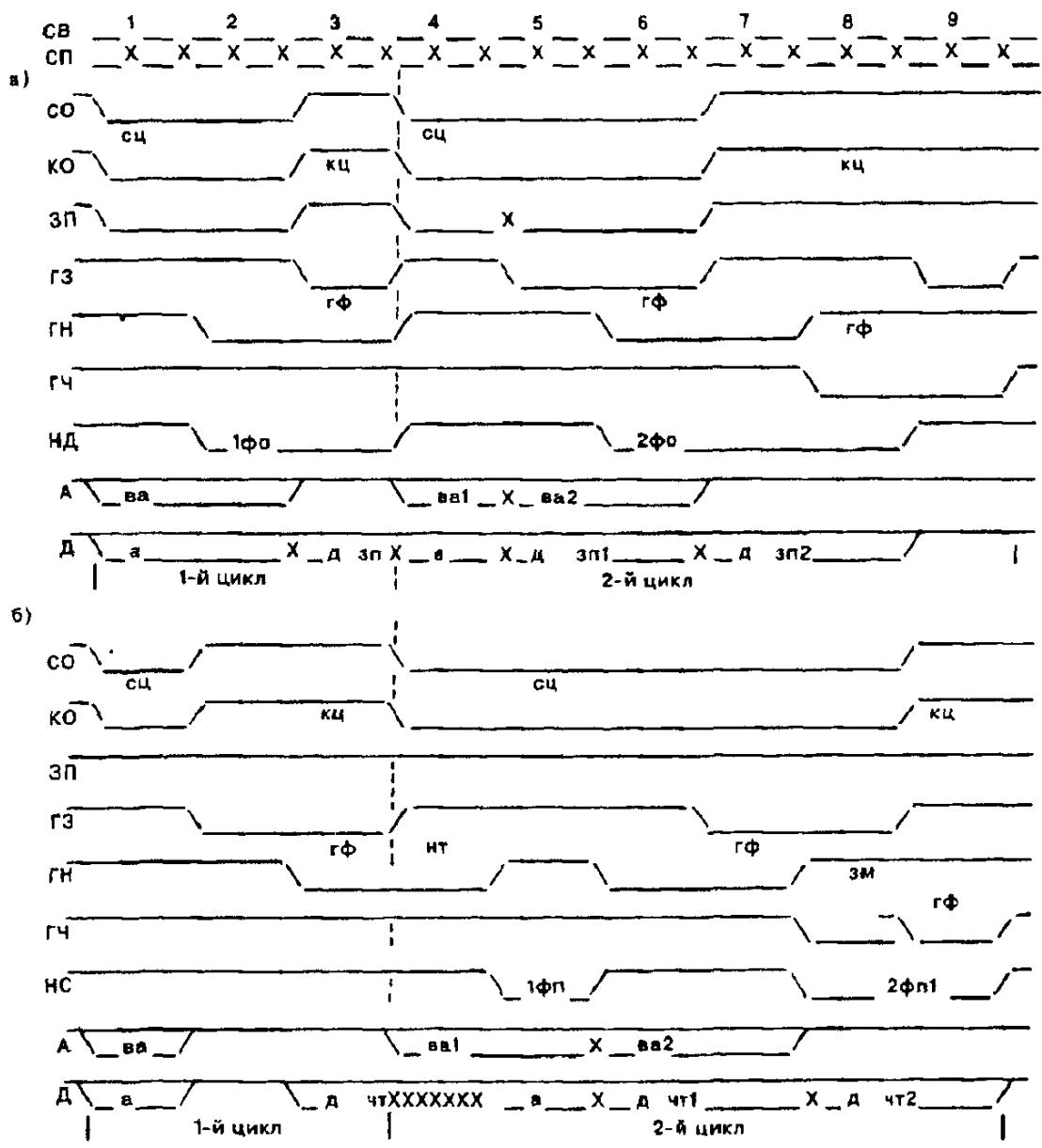
1) мгновенный задатчик (1-й цикл) медленный исполнитель (2-й цикл) б) медленный исполнитель (1-й цикл) медленный задатчик (2-й цикл)
