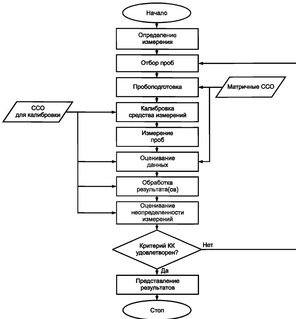
Рисунок 1 — Схематическое изображение измерения и роль в нем ССО
