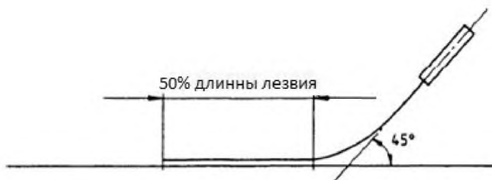
Рисунок 2 - Испытания на прочность лезвия
