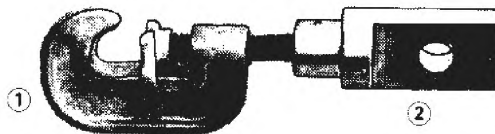
1 — натяжная головка; 2 — однолапчатая проушина
