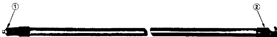
1 — головка в виде гибкого торцевого гаечного ключа; 2 — шлицевой концевик
