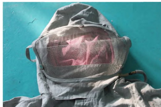
Защитная маска, электрически соединенная с проводящей одеждой
