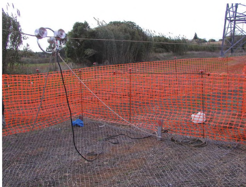
Пример использования ролика заземления
