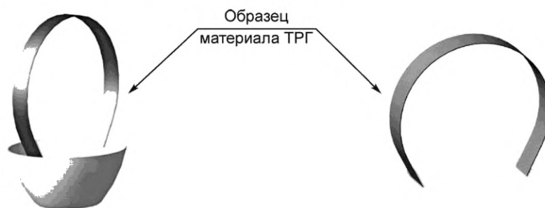
Рисунок И.1 — Схема укладки образцов по способу 1
