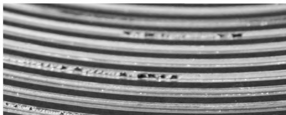
Рисунок 7 — Налипание на вершинах витков резьбы
