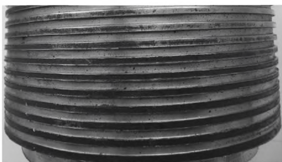
в) Черновины по всей поверхности витков наружной резьбы с полным профилем
