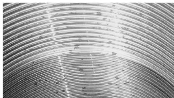
в) Следы коррозии на внутренней резьбе
