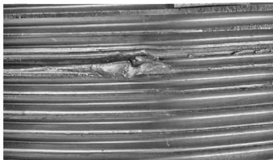
а) Рванина на витке наружной резьбы
