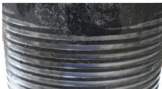
б) Прерванные последние витки перед выходом наружной резьбы
