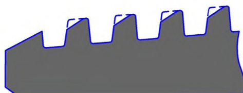
д) Подрез вершины витка резьбы
