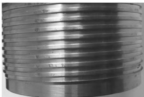
б) Вмятины на вершинах витков наружной резьбы с полным профилем
