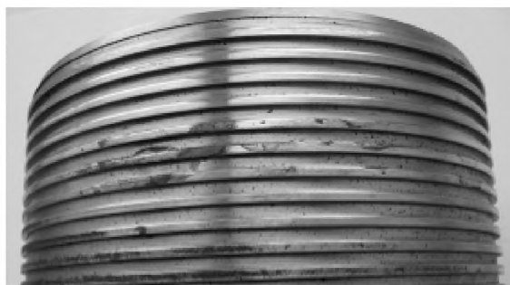
а) Следы коррозии на наружной резьбе
