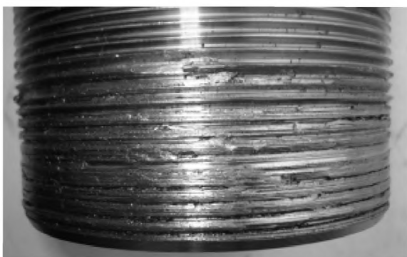
Рисунок 16 — Сорванные витки наружной резьбы
