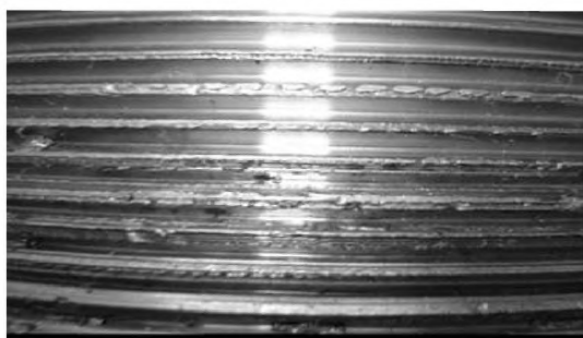
в) Задиры на наружной резьбе после свинчивания
