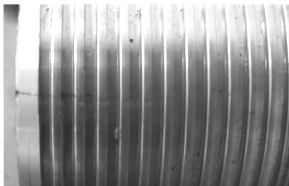
Рисунок 17 — Трещина на заходной фаске и наружной резьбе
