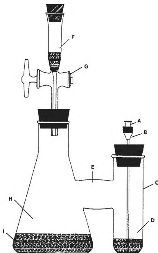
Рисунок 1 - Реакционный сосуд для проведения испытания:
