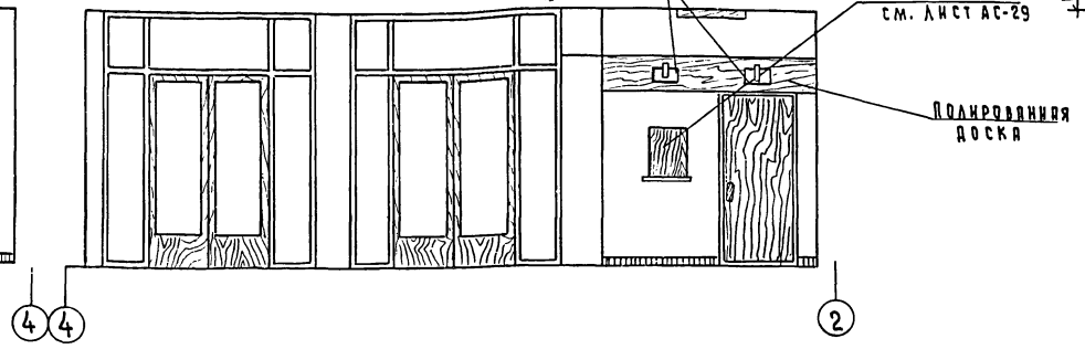
Развертка стены вестибюля в осях 4-2 м 1:50
