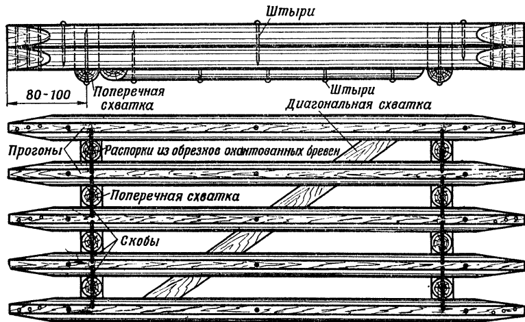
Рис. 19. Блок двухъярусных сложных прогонов
