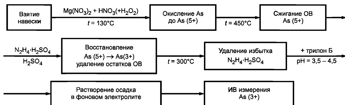
Рисунок 2 — Основные этапы подготовки проб пищевых продуктов и продовольственного сырья при проведении ИВ измерений для определения массовых концентраций мышьяка
