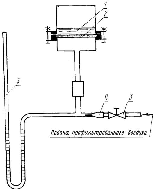
1—жидкость, применяемая для испытаний; 2—испытуемый фильтр; 3—кран регулирования; 4—тормозной капилляр; 5—манометр.
