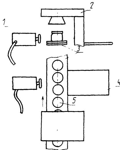
1—устройство удаления негерметичных банок с конвейера; 2—преобразователь линейных перемещений; 3—конвейер; 4—стол для отбракованных негерметичных банок; 5—наполненные укупоренные стеклянные консервные банки».
